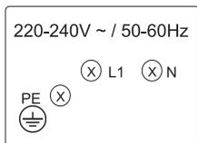
Les appareils d'une largeur de 30 centimètres (avec deux zones de cuisson) ne disposent que d'une seule borne de raccordement pour une connexion monophasée. Le diamètre du cordon d'alimentation doit être d'au moins 1,5 mm<sup>2</sup> !
