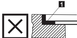
1. Mastic au silicone, 2. Joint d'étanchéité en ruban
