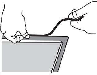
Faites d'abord passer le câble d'alimentation à travers la découpe. Positionnez ensuite l'appareil au centre de la découpe.
